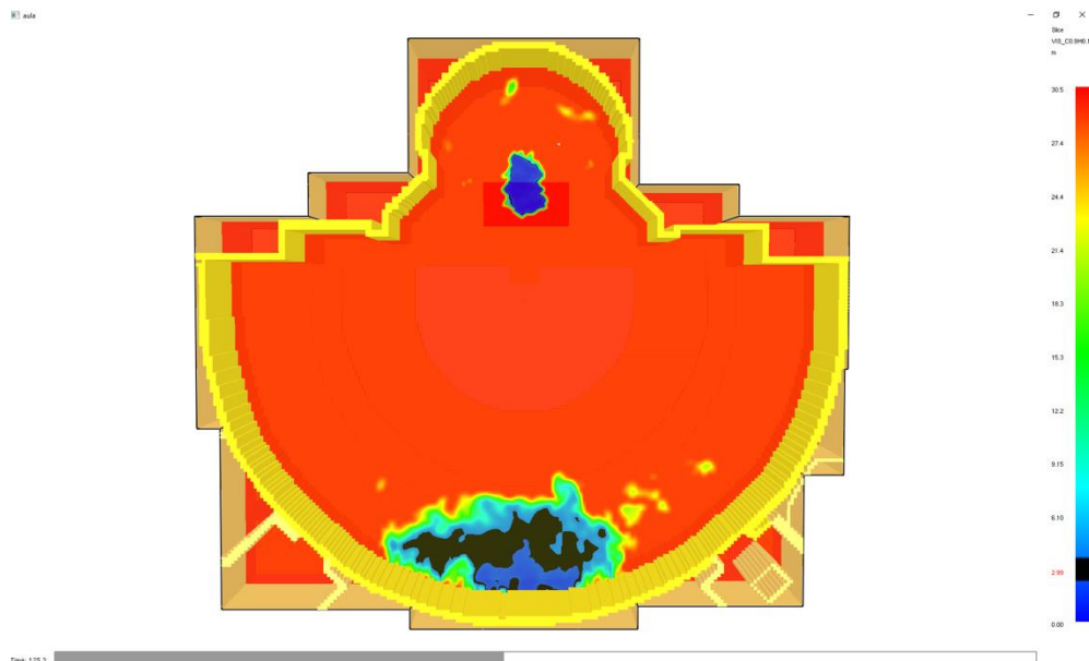
Figur 25: Sikten i aulan vid 8,8 meters höjd efter 125,3 sekunder. Innanför det svarta och mörkblå området är sikten lika med eller mindre än tre meter. Mellan 115–125 sekunder sker det en substantiell tillväxt.
