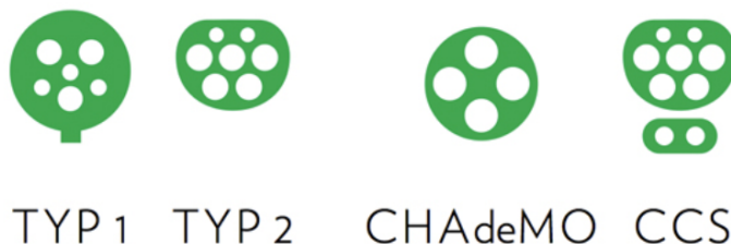
Figur 2.8: Illustration över de fyra vanligaste kontakterna på en elbil. (Emobility, 2018a)
