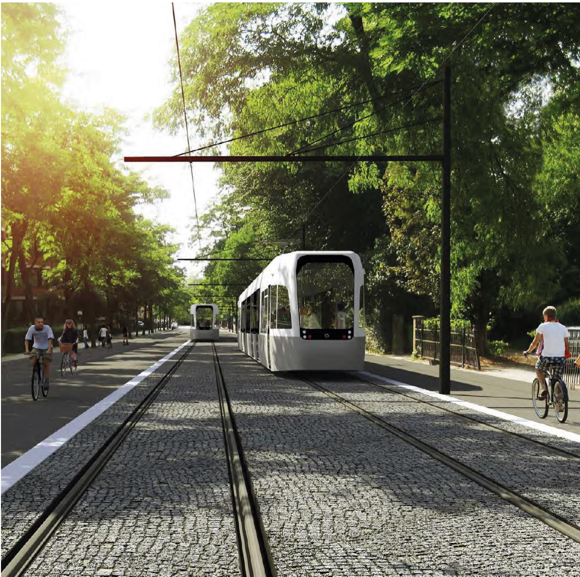
Figur 6.2 Gatusten tillsammans med vita linjen ger en tydlighet för andra trafikanter var spårvagnar kan komma att passera (Källa: Metro Arkitekter åt Lunds kommun, s. 27)
