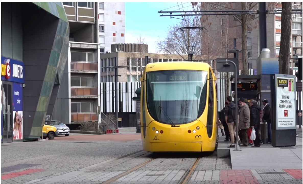
Figur 8.1 Spårväg i Mulhouse, Frankrike. Upphöjd plattform i kombination med spårvagnens låga golv medför plant insteg (Källa: Mazerolles 2018 b).
