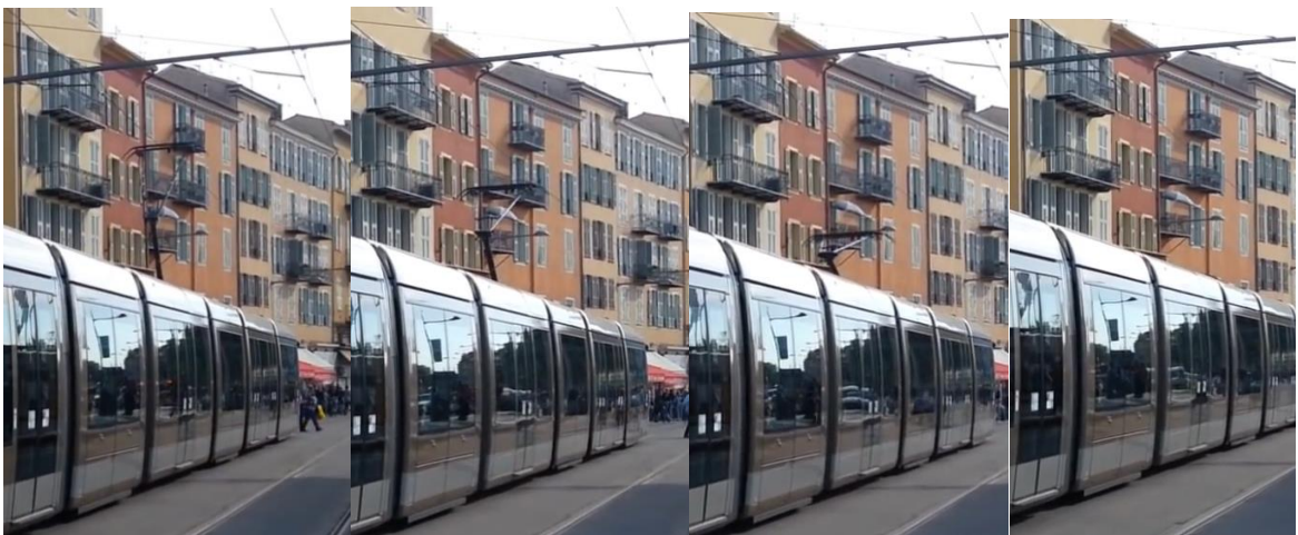
Figur 9.9 Spårvagn i Nice, Frankrike, fäller ner sin kontaktavtagare. (Källa: Benoit Mazerolles 2013)
