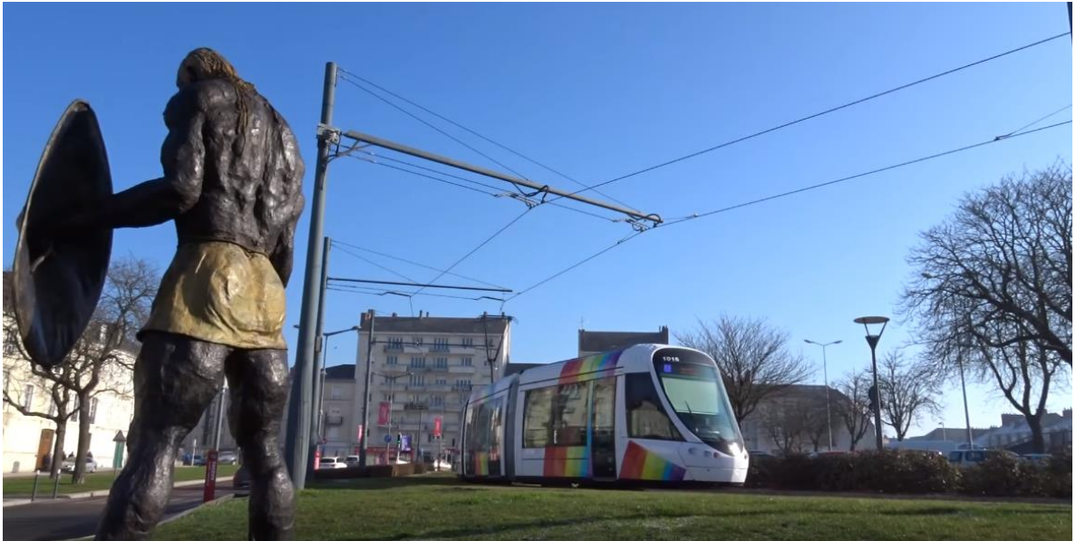
Figur 7.2 Spårväg i Angers, Frankrike, förlagd i gräsplantering (Källa: Mazerolles 2017b).
