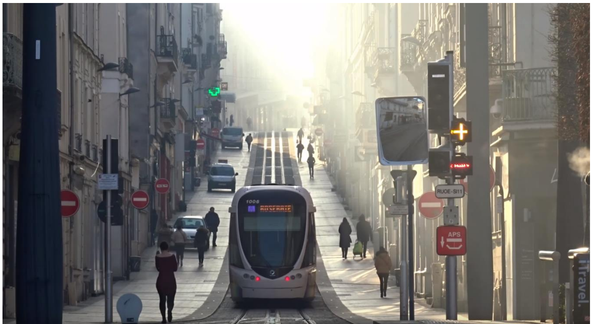
Figur 6.1 Spårväg i Angers, Frankrike. Kontrasten mellan de olika markmaterialen visar tydligt var spårvagnar kan komma att passera samtidigt som det hårda ytskiktet inte utgör hinder för korsande trafikanter. (Källa: Mazerolles 2017 b).
