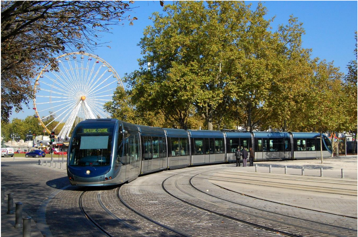
Figur 9.6: Spårvagn i Bordeaux, Frankrike, som kör på APS (Källa: Wikipedia 2008.b).
