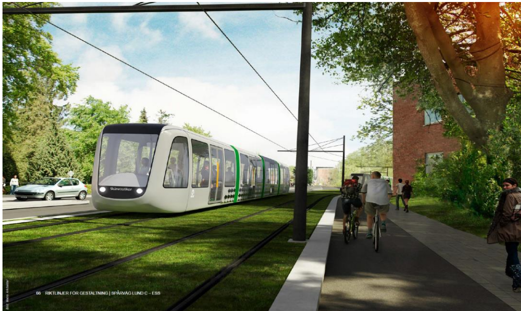
Figur 5.2 Exempel på spårväg på avskilt spår. Utformningsprincip för Lunds spårväg (Källa: Metro Arkitekter åt Lunds kommun, s. 66)
