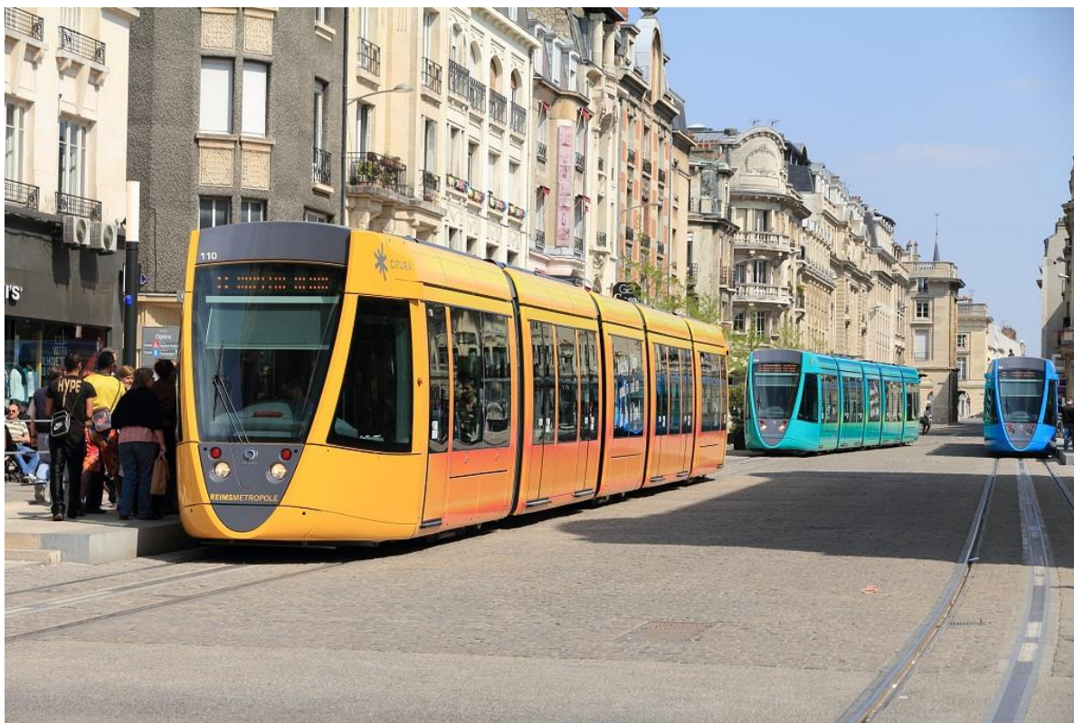
Figur 10.10 Spårvagnarna i franska staden Reims kläs i olika färger. Notera avsaknaden av kontaktledningar tack vare utnyttjandet av APS (Källa: Wikipedia 2011).
