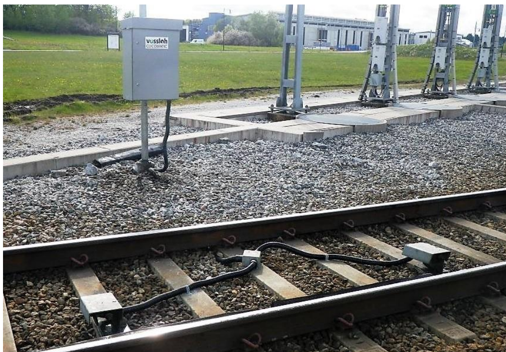
Figur 1 Driftsatt Clicomatic ® i utförande med dubbla skottventiler.
