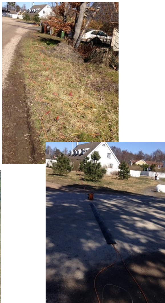
Fig. 8. Foton av elektroduppställningen för mätlinje 2. Till vänster visas starten av mätlinjen och till höger dess slut och delen av mätlinjen som korsade vägen där inga elektroderna kunde sättas ner i marken.
