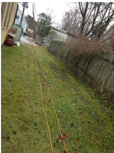
Fig. 9. Foto av elektroduppställningen för mätlinje 3.
