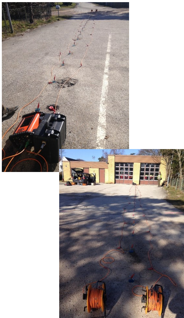
Fig. 10. Foton av elektroduppställningen för mätlinje 4. Till vänster visas starten av mätlinjen och till höger dess slut.
