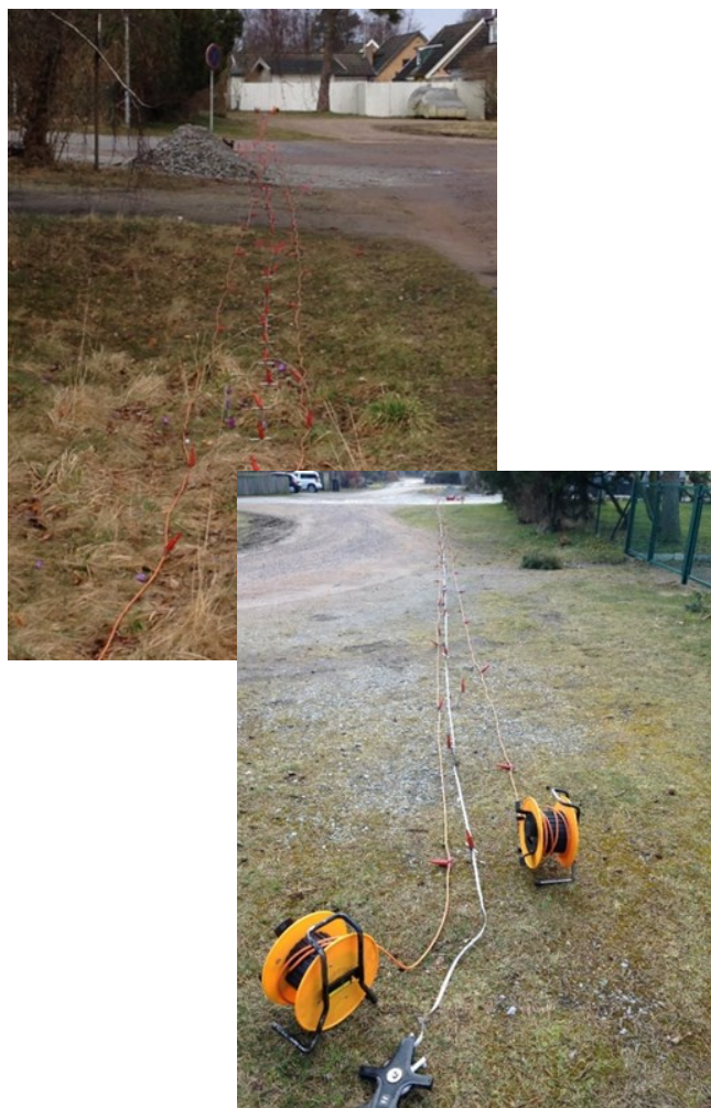
Fig. 7. Foton av elektroduppställningen för mätlinje 1. Till vänster visas starten av mätlinjen och till höger dess slut.
