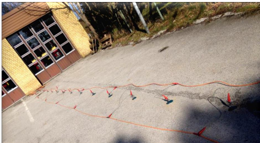
Foto av resistivitets- och IP- mätning vid brandstation i Vellinge kommun.
