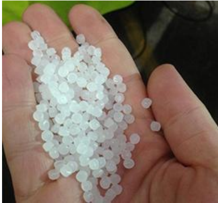
Fig. 7. Polyeten i form av plastgranulat
