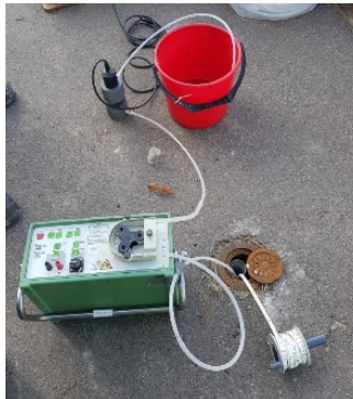
Figur 5. Uppställning av lod, peristaltisk pump och flödescell.
