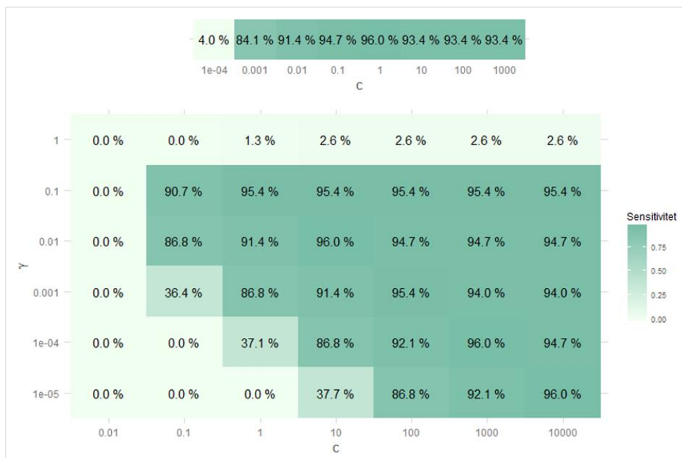
Figur 8.1 Illustration av korsvaliderings-sensitiviteten givet olika kombinationer av parametervärden. Den högsta sensitiviteten hittas vid c=1 för den linjära modellgruppen (övre delen), och c=10 och \gamma=0.01 för den Gaussiska modellgruppen (undre delen). Dessa två modeller väljs ut för vidare analys.
