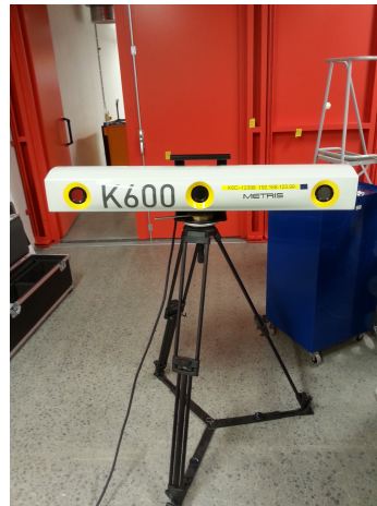
Figur 2: Nikonkameran vid kinematiska kalibreringen.
