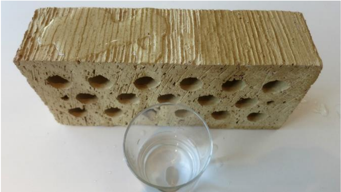
Figur 13: Efter 5 minuter har nästan allt vatten absorberats på den obehandlade sidan (Morneon fasad (u.å.))
