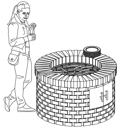
Lucka för införel av ved
