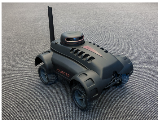
Figur 1: Hamster V5 – det småskaliga fordon som använts för att testa och vidareutveckla banplaneringsalgoritmen under arbetet. Fordonets längd är 25 cm.
