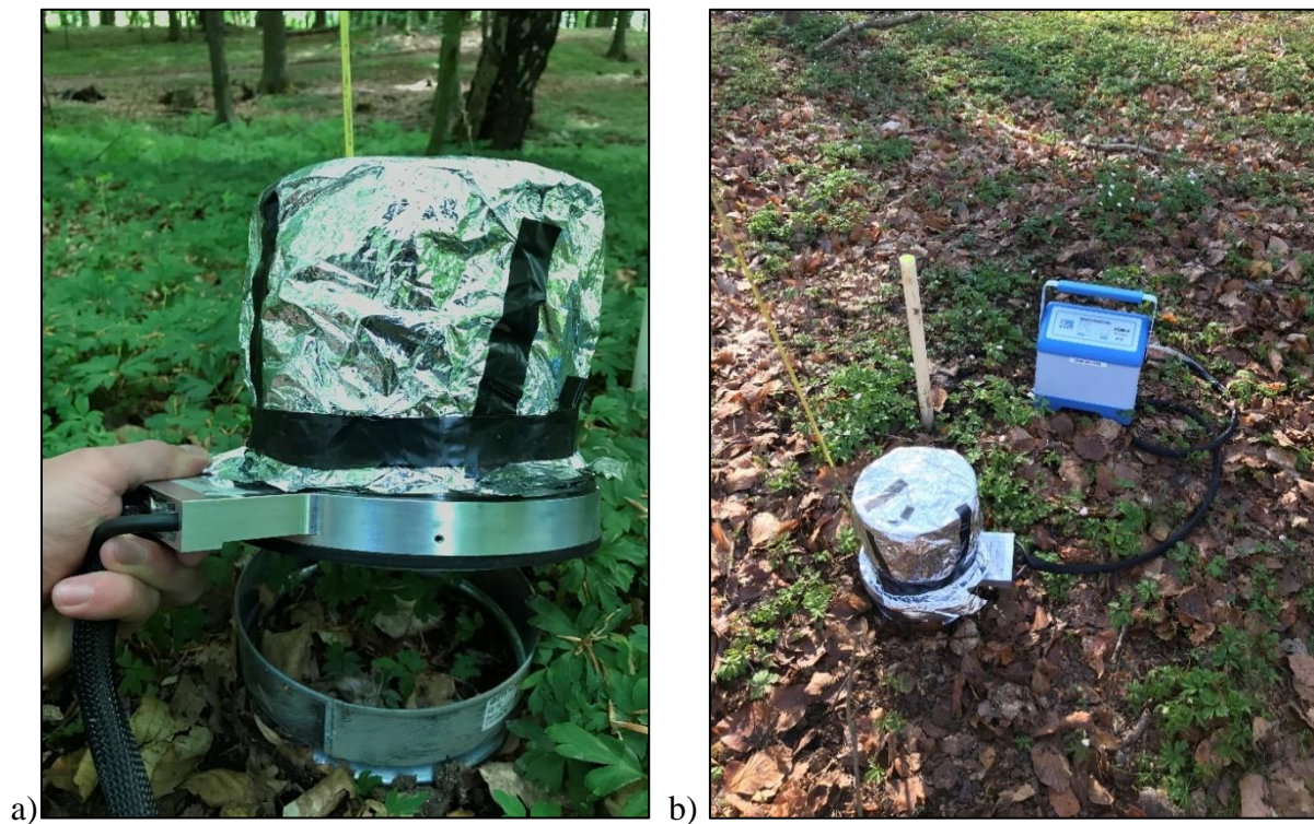
Figur 3. Efter att ha "sköljt" kammaren genom att hålla den i luften 30 sekunder, a) placerades den försiktigt på aluminiumramen varpå en b) mätning gjordes under 180 sekunder.
