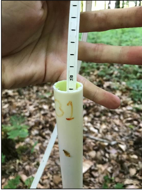
Figur 4. I förekomst av grundvatten lästes nivån av på mätskalan på det elektroniska lodet.
