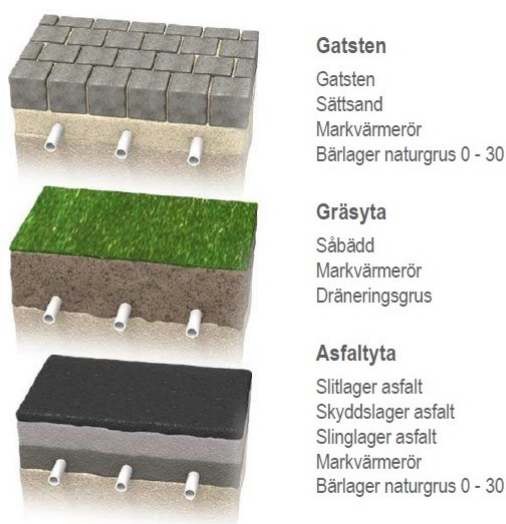
Figur 4: Förläggningsexempel gatsten, gräsyta och asfalt (Sant 2018)
