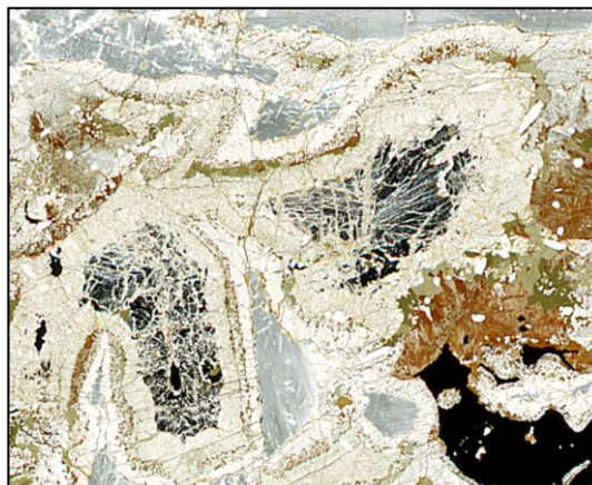
Figuren visar ett tunnslip av en omvandlad metamorf bergart med en sk. koronitisk textur. Man kan urskilja en grönaktig och en vit ring runt de mörkare mineral som förekommer i tunnslipet detta ger bergarten en koronitisk textur.
