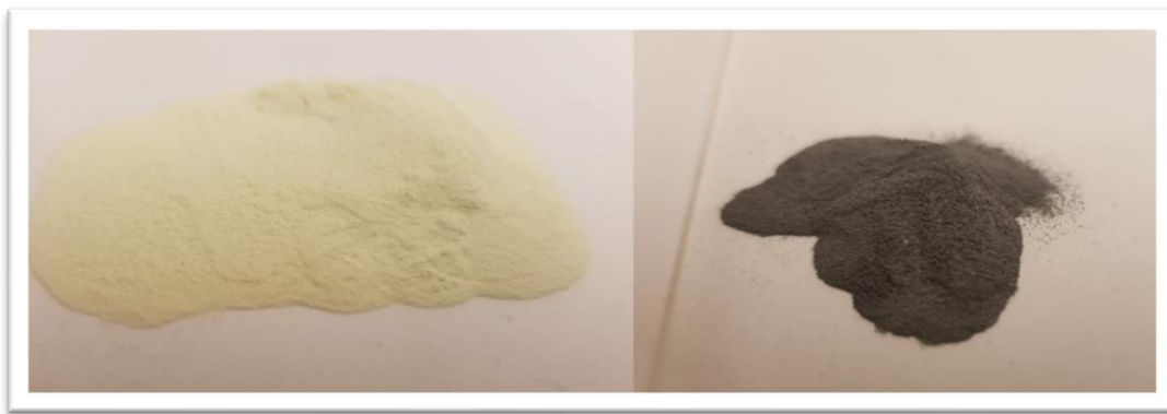
Figur 11. Till vänster: Ljust släckpulver Till höger: Ljust släckpulver blandat med 10 % kimrök
