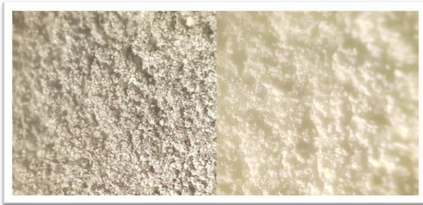
Figur 10. T.v. Mörkkolorerat släckpulver. T.h.: Ljust släckpulver
