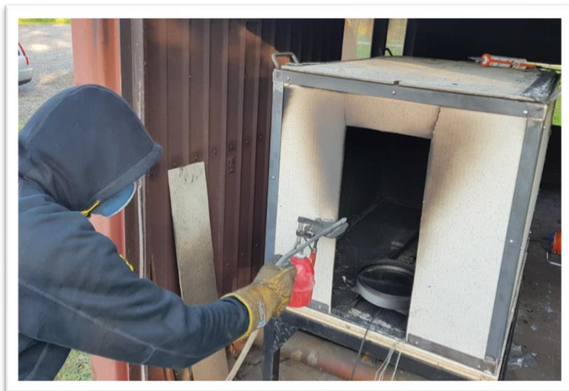
Figur 13. Påföringsteknik under försöken
