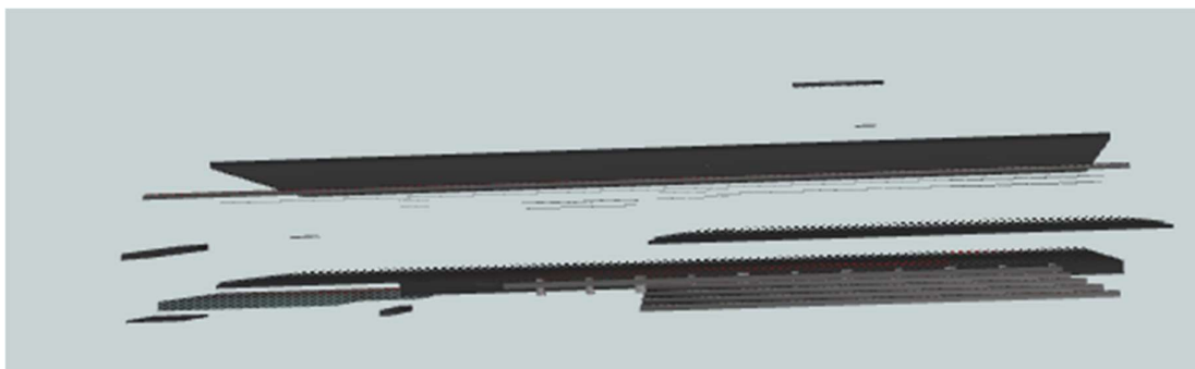
Figur 5.1 Enligt handledning utan extra element. Ingen väggeometri syns eftersom IFCSpace saknas i modellen. Visualiserad med FMEs egna visualiseringsprogram.
