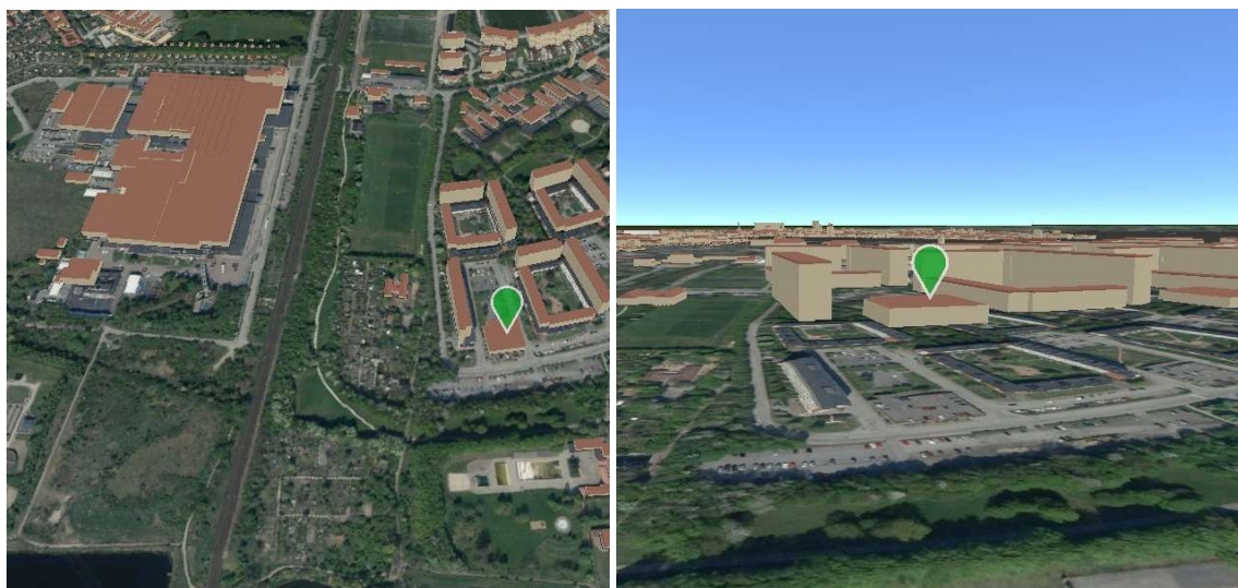
Figur 5.8 Visualisering av Lunds LOD2 stadsmodell. Till vänster är modellen orienterad ortogonalt och tycks ligga någorlunda rätt georefererat. Till höger svävar byggnaderna när de visualiseras från markplan.
