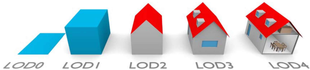
Figur 1.4 Modell av de olika detaljnivåerna som sedd i Donkers et al. (2016) efter Biljecki et al. (2014a)
