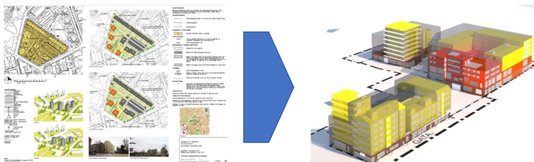
Figur 2.2 principiell jämförelse mellan 2D- detaljplan och 3D-detaljplan. Bearbetad från bilder ur Ljungblom et al. (2017). Texten i den vänstra bilden är detaljplanebestämmelser och beskrivning av byggnaderna i 3D. Den högre bilden är av ett annat område men med detaljplanebestämmelser i en 3D-modell.
