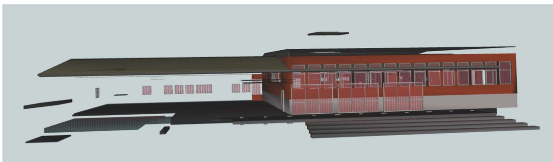
Figur 5.2 Enligt skriptets handledning med extra element. För att få fram väggarna används IFCRoof, IFCWindow och IFCWall. Visualiserad med FMEs egna visualiseringsprogram.
