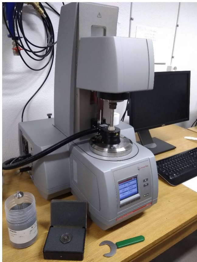
Figur 3.1-1 - LTH:s MCR 302 och PP08 spindel
