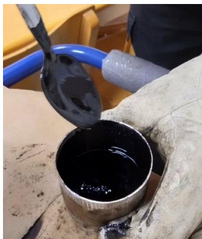
Figur 3.1-2 - Blandning av bruk och bitumen med uppvärmdsked
