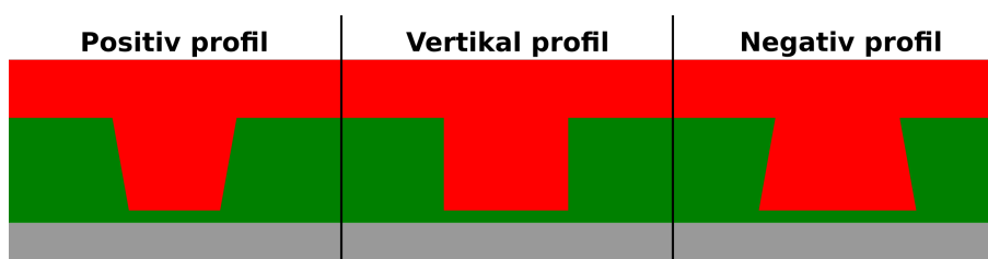
Exempel på de tre typerna av sidoväggprofil: positiv, vertikal och negativ.
