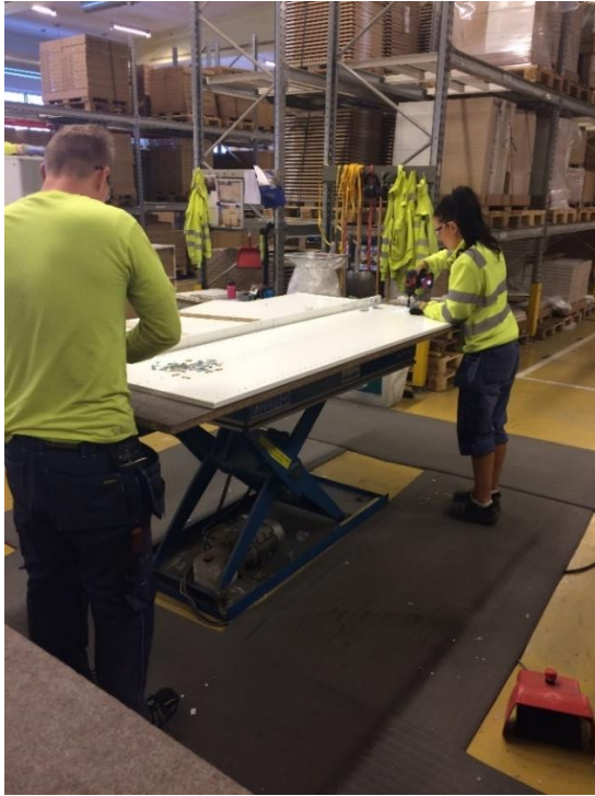
Figur 17. Montering av garderob som sker under ergonomiska förutsättningar.
