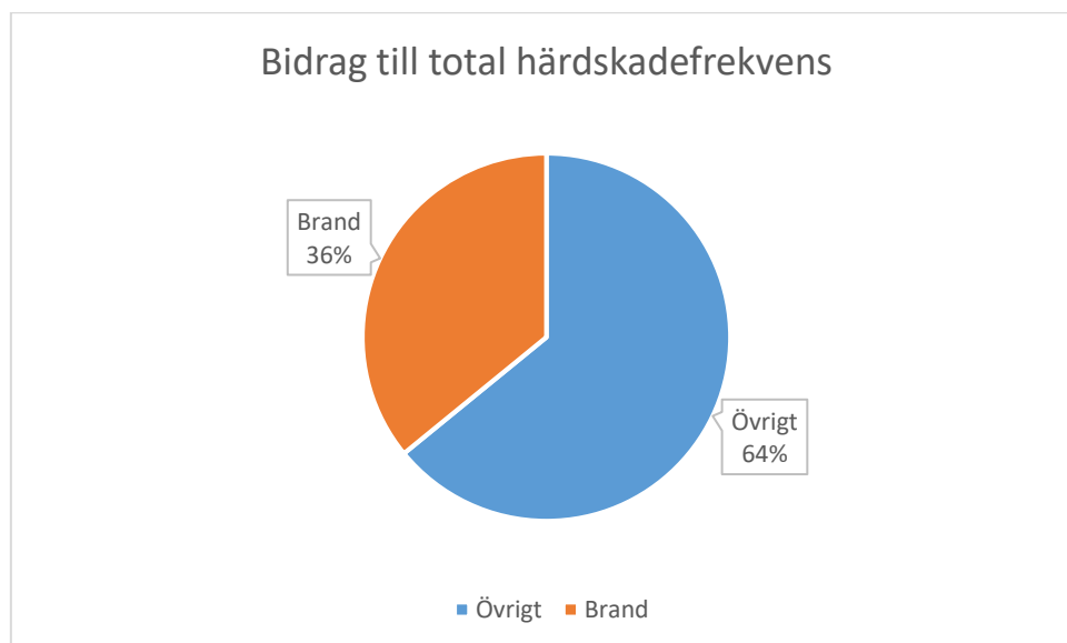
Figur 2 visar bidrag till total härdskadefrekvens på Ringhals reaktor 3.
