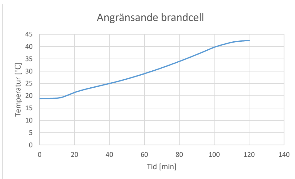
Figur 16 visar temperaturen i den angränsande brandcellen.
