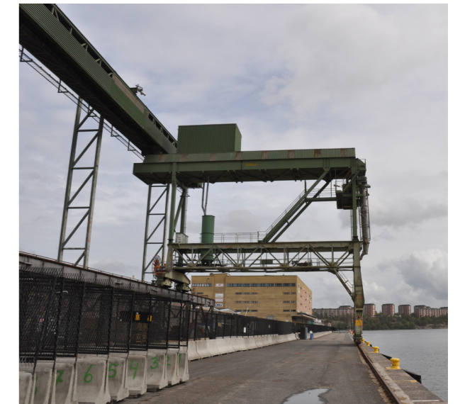
Ovan: Skeppslastaren som kan köra längs kranbanan framför silosarna för att lasta fartyg med spannmål.
