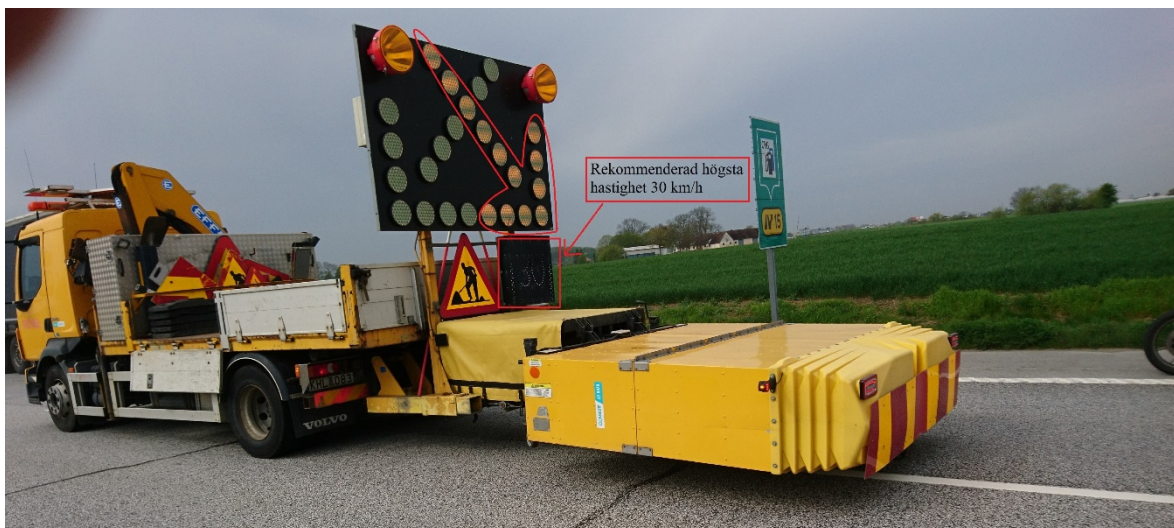
Figur 10. Förtydligande TMA-fordon med blinkande gul ljuspil och rekommenderad högsta hastighet 30 km/h.
