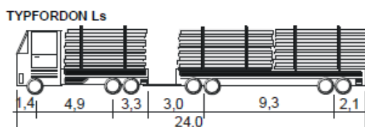
Figur 5. Figuren visar typfordon Ls med utsatta mått (Trafikverket, 2015).
