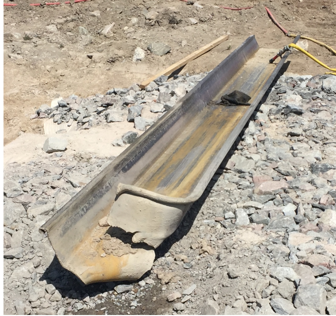
Figur 3.4: Skadad spontfot från en av entreprenaderna i projekt Förbifart Stockholm, från Trafikverket (u.å.). Foto: P. Björgulfsson.
