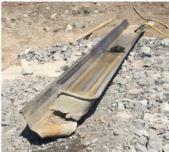
Figur 1: Exempel på skadad spontplanka från projekt Förbifart Stockholm. Foto: P. Björgulfsson.
