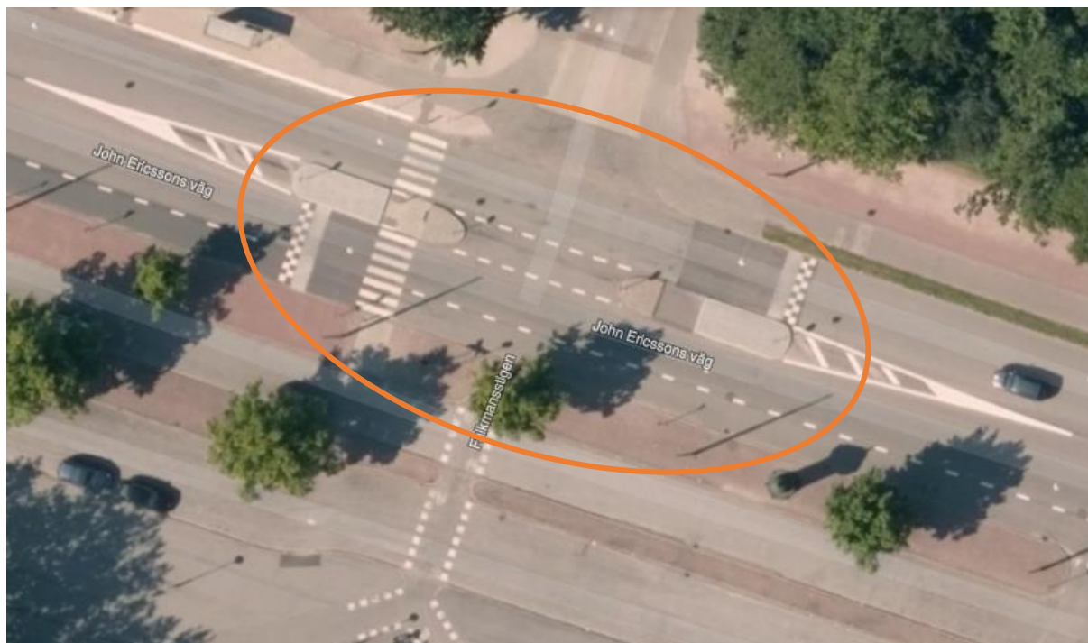
Figur 9. Korsningspunkten John Ericssons väg/Baltiska vägen och dess detaljutformning före införandet av cykelöverfarter i korsningspunkten. Platsen för cykelöverfarter utmärkt med orange oval. (Openstreetmap, 2019)
