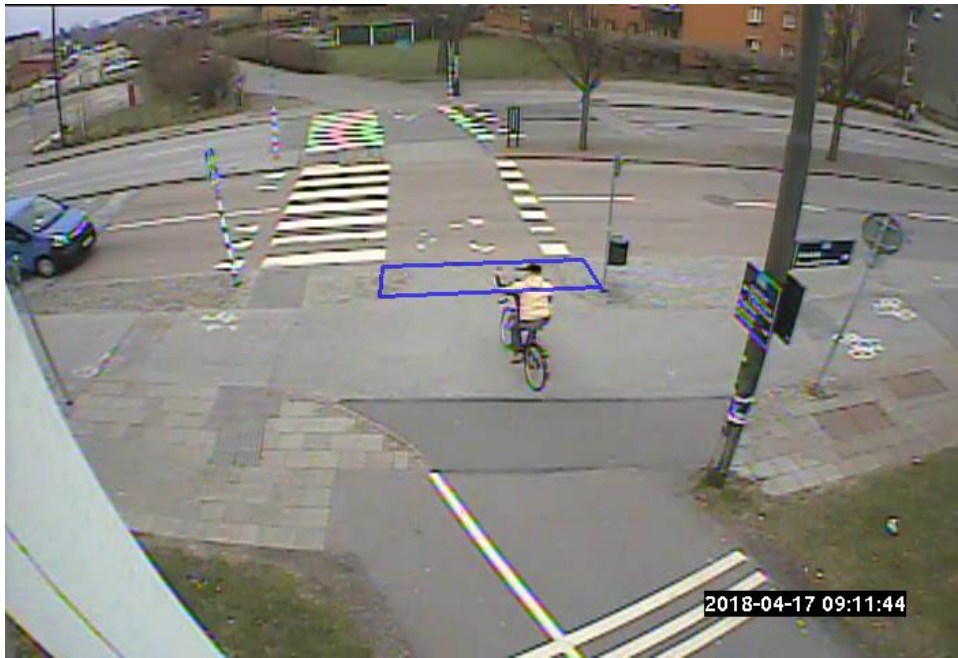
Figur 11. Visar en stillbild som klippts ut ur det videofilmade materialet med RUBA. Den blå rektangeln är den utplacerade detektorn som detekterar trafikantens närvaro, i det här fallet cyklisten.
