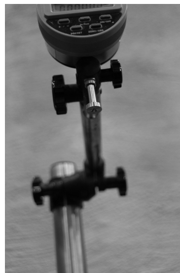
(c) Konkav urgröpning kopplad till en mätklocka.
