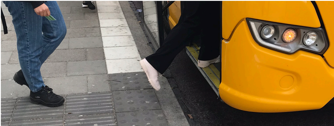
Bild 15, Plattformshöjd i förhållande till bussens höjd. För plan instigning hade bussen behövt niga. (författarens bild)
