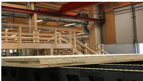
Figur 5.1. Tillverkning av KL-träskivor i fabrik KL-träskiva rullande på en "CLT turning device", efter att limmet mellan lamellagren har applicerats och pressats. (Författarna 2019).
