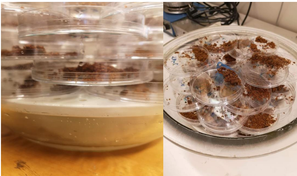
Bild 4. Lagring av prover i exsickator med saltlösning, RH och temperaturlogg.
