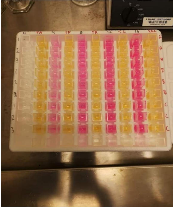
Bild 6. Lagringsprover (gula) och prover för standardkurva (rosa) för mätning av sekundäroxidation.
