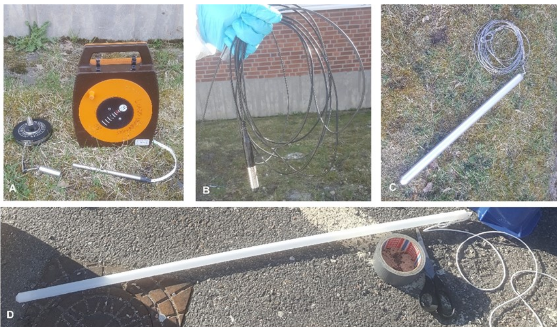
Fig. 8: Material som användes i samband med slugtest och inmätning av tryckyttenivåer. A: Klucklod (vänster) och ljuslod (höger) använda för att mäta tryckyten innan slugtest samt under slugtest för att följa återhämtningen. B: Automatisk trycknivåmätare av sorten MICRO-DIVER använd för att erhålla data från återhämtning under slugtest. C: Metallstång, även kallad slug, använd för att störa tryckyten i de undersökta brunnarna. D: Bailers, samma användning som slug.
