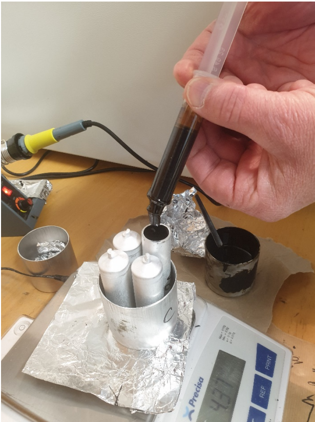
Figur 24 Asfaltbruket sprutas ner i provrören
