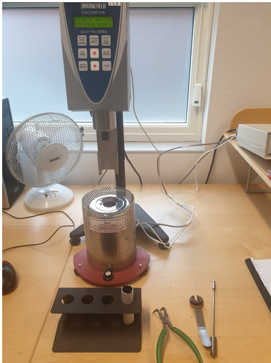
Figur 2 Rotationsviskosimeter, RVB med tillhörande värmelement, spindel, lock, tång samt provrör med provrörshållare
