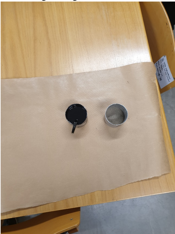
Figur 18 Bitumen och filler innan blandning i färdiga mängder.
