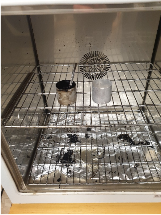
Figur 17 Bitumen och filler i ugn för uppvärmning.
