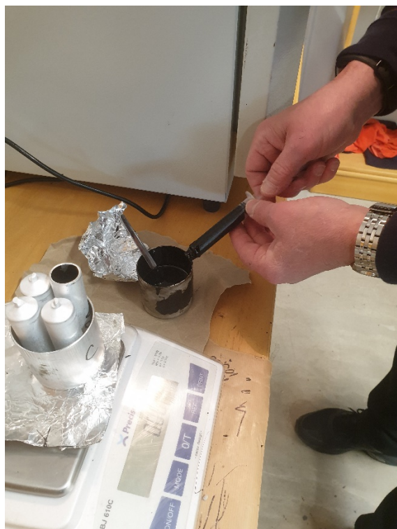
Figur 23 Uppmätt mängd asfaltbruk i spruta
