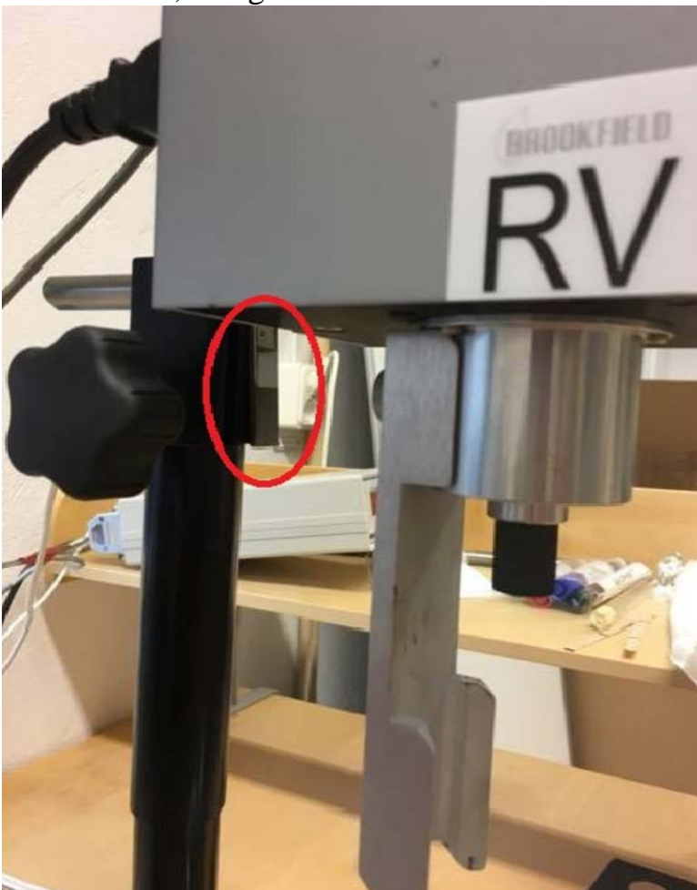
Figur 29 Spak för höjning och sänkning av spindel [31]
