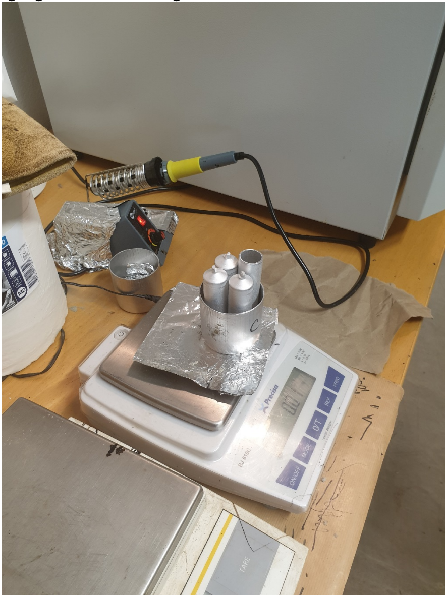
Figur 11 Provrör i burk vid uppvägning på våg med noggranhet 0,01 g samt tillhörande värmesked
