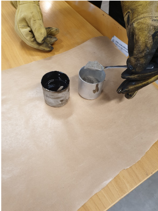
Figur 19 Filler matas in i omgångar i bitumen.
