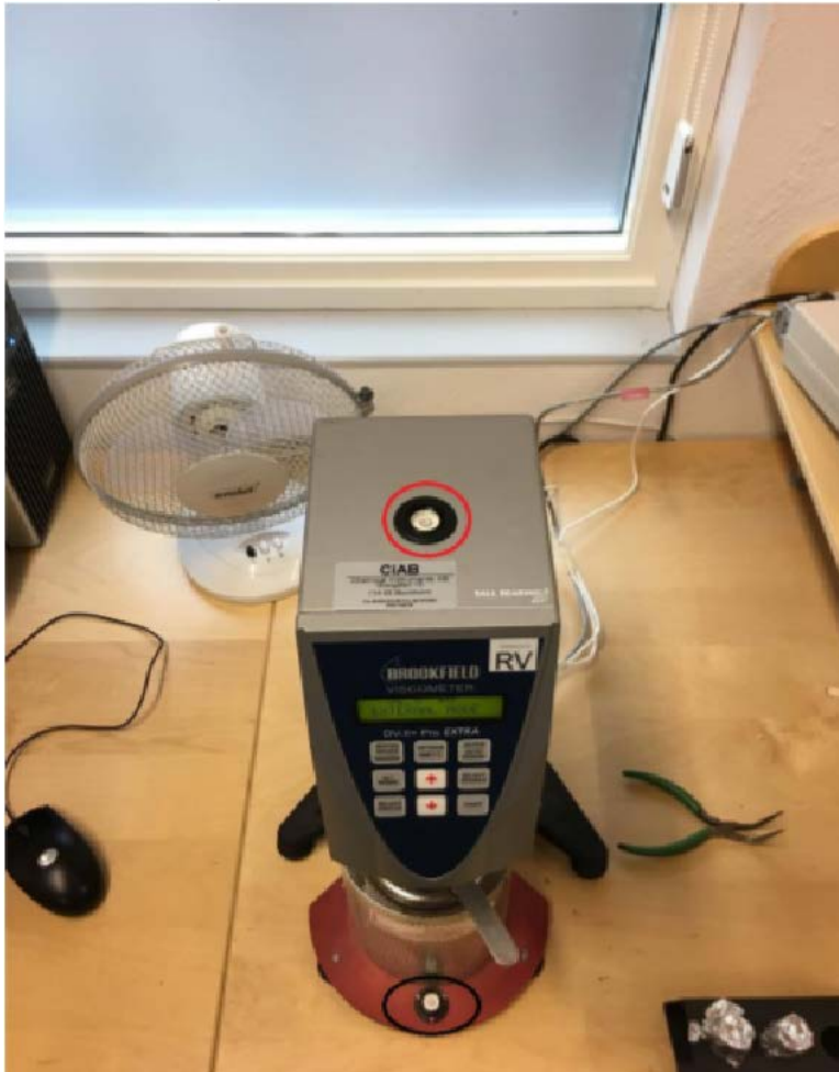
Figur 30 Vattenpass på RVB och värmeelement [31]
