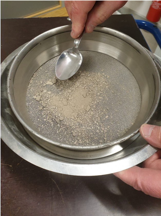
Figur 13 Filler med klumpar på sikt 0,125 mm.
