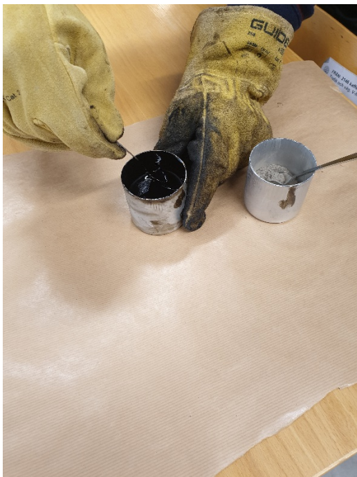
Figur 20 Filler och bitumen blandas till en homogen blandning
