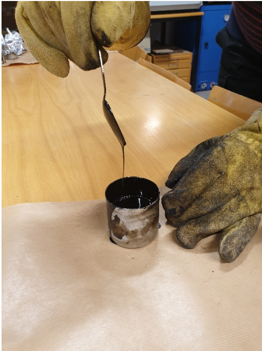
Figur 21 Homogen blandning av filler och bitumen
