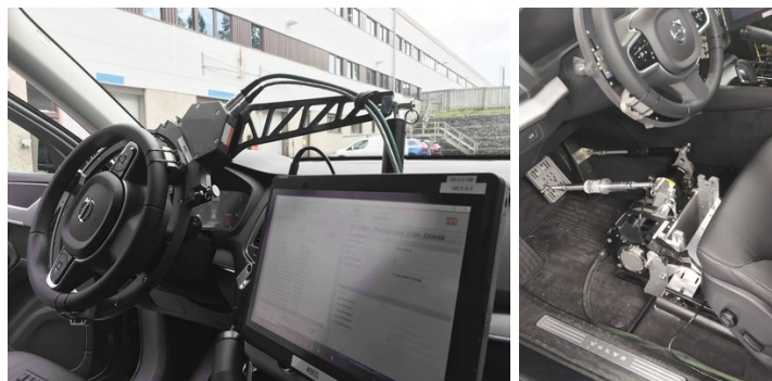
Figur 1: (Vänster) Styr-roboten som används i det robotiserade ramverket. (Höger) Pedal-roboten som används i det robotiserade ramverket.
