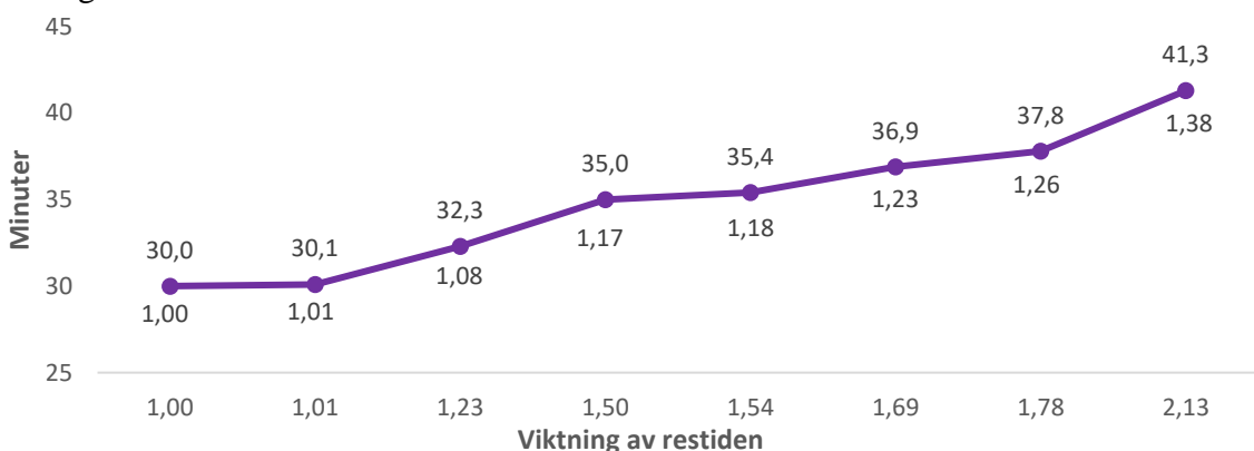
Figur 20. Skillnaden i upplevd restid till följd av trängsel på tåget på sträckan Malmö-Lund med Öresundståg i båda riktningar. Övre siffran anger den upplevda restiden i minuter, den undre siffran anger kvoten mellan aktuell upplevd tid och kortast upplevda restid till följd av trängsel.
