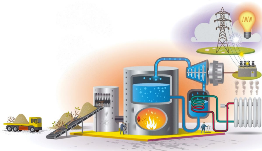
Figur 11 Illustrationsbild hur kraftvärme fungerar (Energiforetagen 2018).
