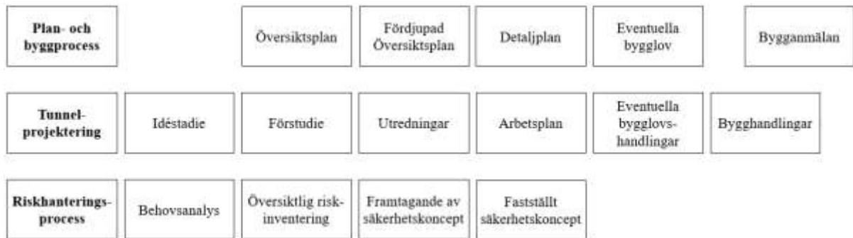
Figur 1: Överskådlig bild av projekteringsprocessen för tunnlar.
