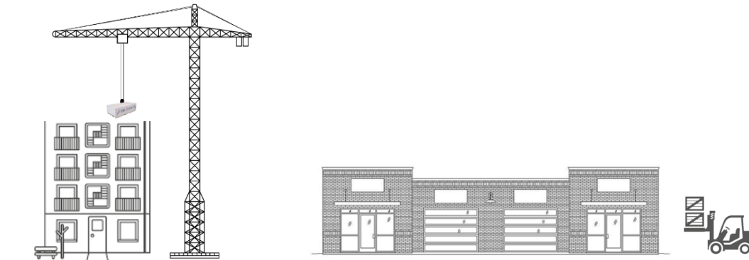
Figur 29 Figur beskrivande två möjliga förfaranden vid transport av gips in på byggarbetsplatsen. Till vänster; Gips tas in under stomresning, till höger: Gips tas in under stomkomplettering.
