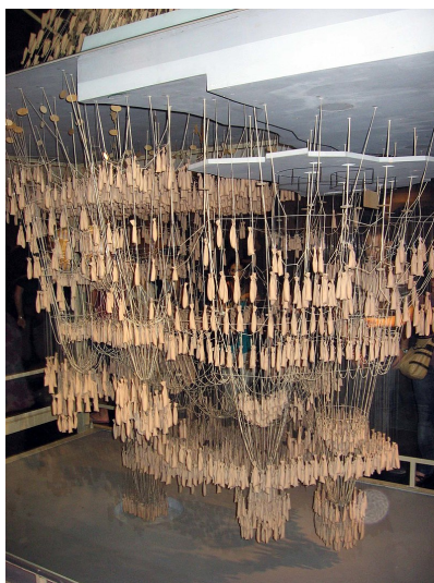
Figur 2.1: En upp- och nedvänd kraftmodell av Colònia Güell, Sagrada Família Museum. (Commons, 2017a)
