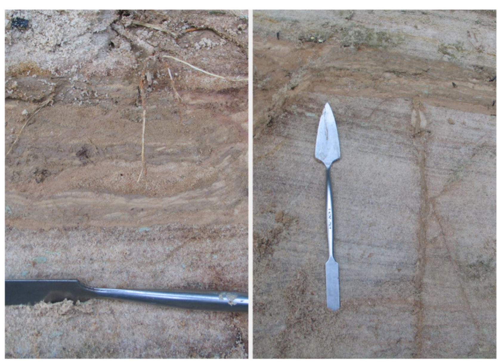
Fig. 2. Närbilder över partier av det hydrauliska spräckningssystemet i Meads of St John i Skottland. Det injekterade materialet uppvisar lagringar vilka antyder att de avsatts genom flödande vatten. Bilden är tagen av S. Lukas.
