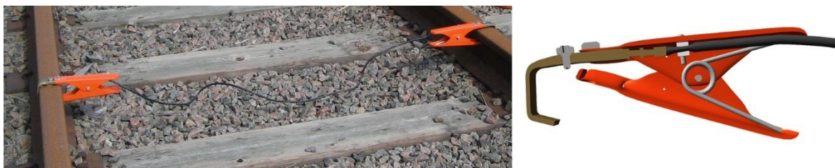
Figur 20: Kontaktdon som används för att kortslua spårledningar vid bl.a. underhållsarbeten (Safetrack, 2019).
