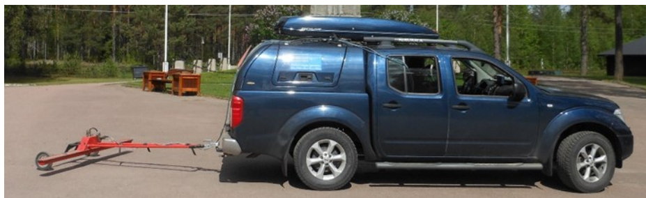
Fig. 18. Fältmätningssystemet som användes av SGU för att utföra georadarundersökningarna över grundvattenmagasinet Verveln – Gullringen. I bilden syns en personbil med en släpanordning där georadarsystemet SIR 3000 från GSSI var monterat. Bildkälla: Mattias Gustafsson SGU
