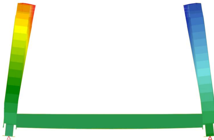
Figur 4.26 Principiell illustration av utböjning i tvärled
