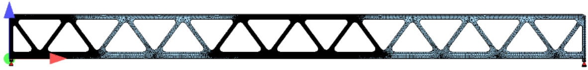
Figur 4.3 Principiell visualisering av meshning för fackverksram
