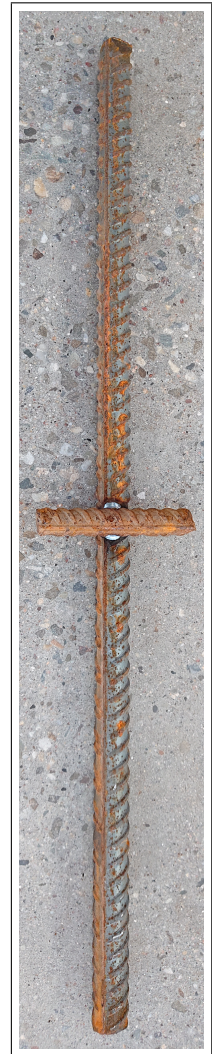
Figur 1: Visar hur en provkropp såg ut. Provkroppen var svetspåverkad genom en punktsvets mitt på järnet.
