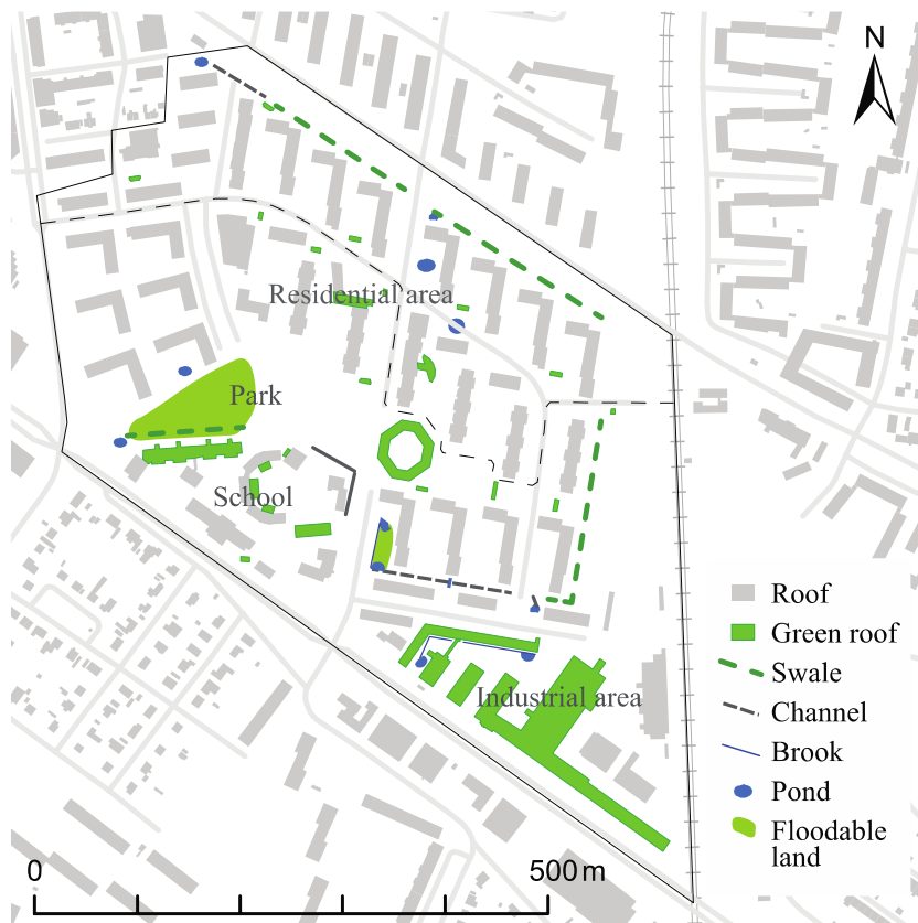
Figur 4. Schematisk karta av Augustenborg och dess blågröna infrastruktur. Gränsen mellan det norra och södra är markerat med en svart streckad linje. (Green roof = gröna tak, swale = svackdike, channel = dagvattenkanal, brook = bäck, pond = dagvattendamm, floodable land = översvämningsbar mark) Fig.3 (Sörensen & Emilsson, 2018)
