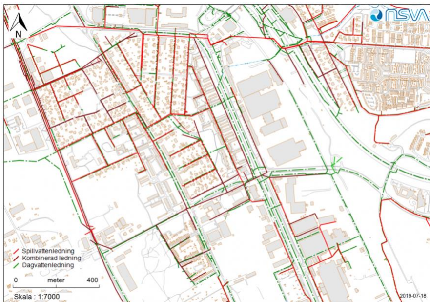
Figur 3. Översiktsbild av undersökningsområdet i Miatorp. Dagvattenledningar symboliseras av gröna linjer, spillvattenledningar symboliseras av röda linjer och kombinerade ledningar symboliseras av bruna linjer. (VA- banken, 2019)
