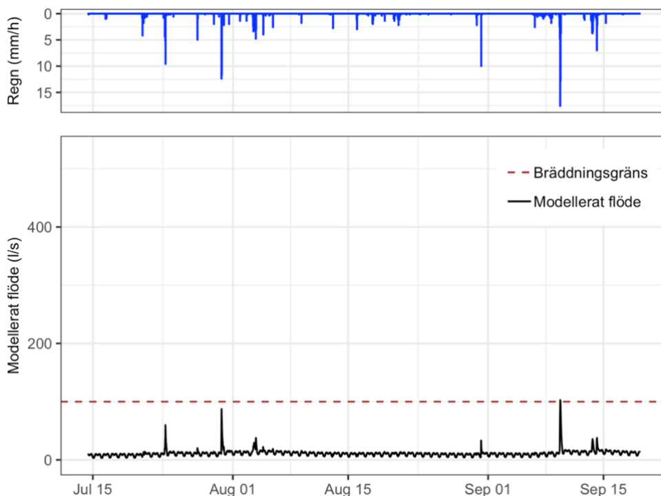
Figur 26. Uppmätt regn (mm/h) och modellerat flöde (l/s) då 95 % av Miatorps area är blågrön. Regnserien är uppmätt vid Dunkerska huset i Helsingborg under en mycket regnrik period uppmätt 2017-07-16 / 2017-09-18. Bräddningsgränsen är markerat med brun streckad linje.
