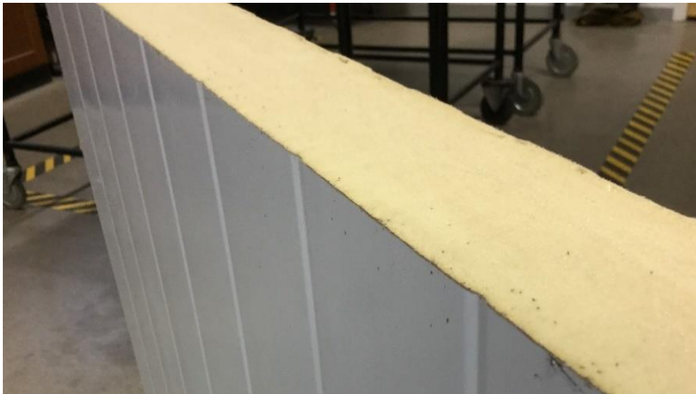
Figur 1: Sandwichpanel med PIR-kärna och ytskikt i stål.
