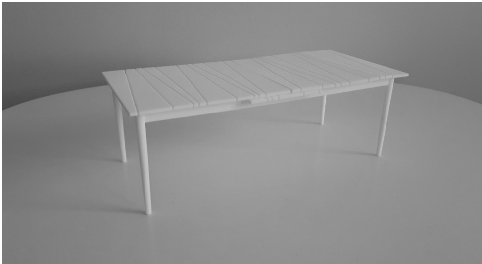
Figur 12.1 3D-printad prototyp av bordet.
