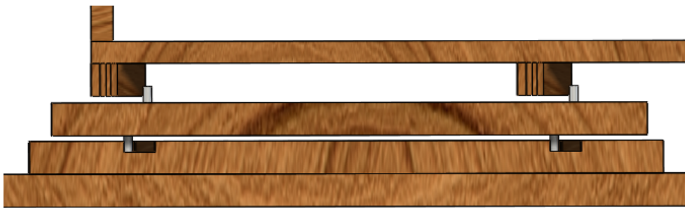
Figur 11.4 Mekanisk lösning på ena sidan av bordet som gör iläggsskivan höj- och sänkbar.
