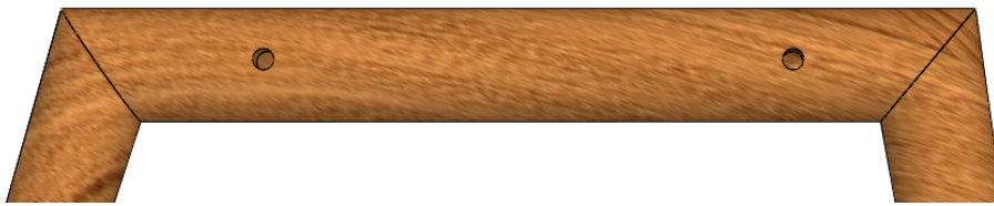
Figur 11.8 Förborrade skruvhål i benstommen för att kunna fästa benstommen i stolsitsen.
