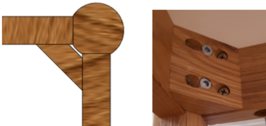
Figur 11.7 Förstärkning i ena hörnet av bordsramen.
