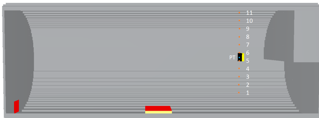
Figur 9. Modell av cisternen invändigt. Siffrorna 1-11 motsvarar termoelement, PT motsvarar plattermoelementet.
