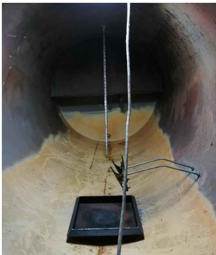
Figur 5. Invändig bild av cisternen visar bränslekärl, tändanordning och termoelementträd. Närmst i fotot syns repet till en sele som en av laboranterna hade på sig, denna är inte en del experimentuppställningen.
