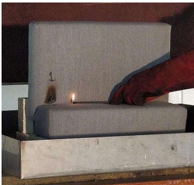
Figur 7 Applicering av låga på provdel.
