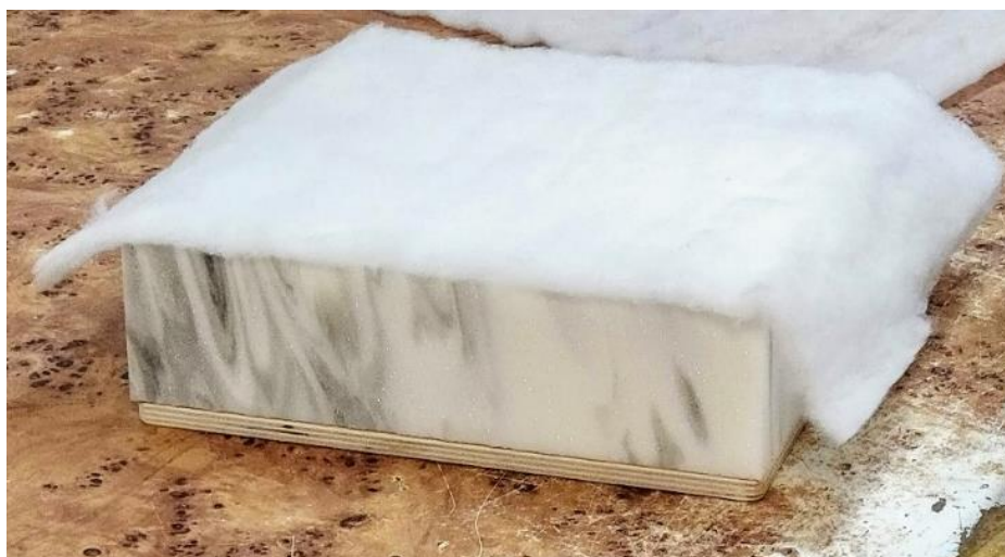
Figur 3. Bild på interliner och stoppning innan tyg fästs.
